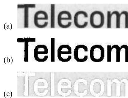
Figure 4 : Imagerie du mot « Telecom » : (a) initiale ; (b) après binarisation ; (c) fond extrait.
